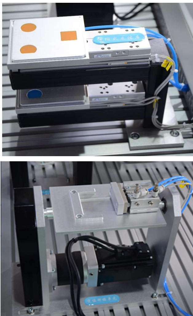
图 1-2 变位机定位夹具及电磁阀气路连接后的效果
