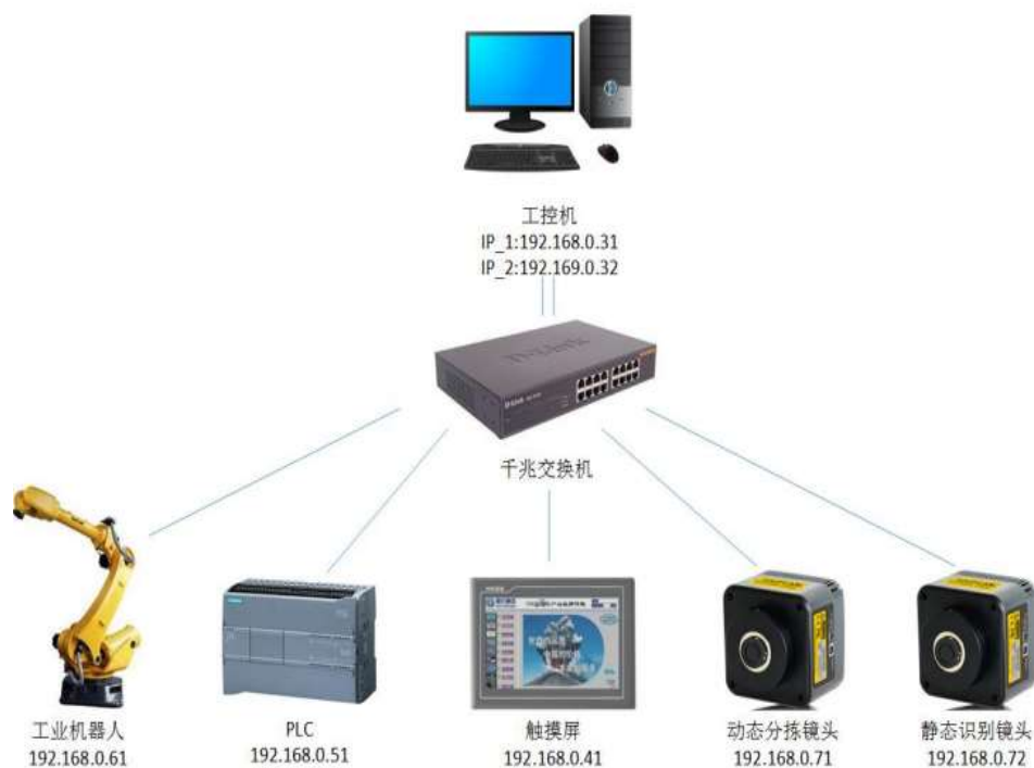
图 2-1 相机和编程计算机的连接示意图
